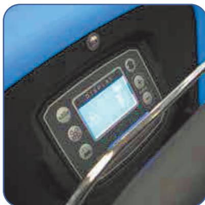
Pannello comandi analogico, semplice ed intuitivo. Interruttore ON/OFF ed interruttore a chiave per esclusione batterie, interruttore motore spazzole e motore aspirazione.
