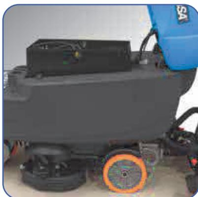
qualsiasi tipo di sporco da tutti i pavimenti. Robuste ruote in poliuretano antiolio. Vano batterie per batterie da 500 Ah C5 che consentono lunghi tempi di lavoro in continuo.
